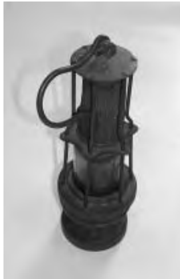
Lampada grisoumetrica a benzina.
